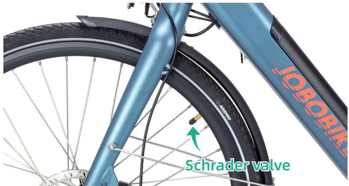
Vérifier que le talon des pneus et le pneu sont uniformément fixés sur les jantes. Utiliser une pompe avec une valve Schrader et un manomètre pour gonfler chaque pneu à la pression recommandée indiquée sur le flanc du pneu.
