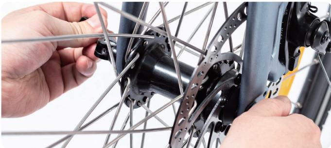
3. 1 Préparer et placer la roue avant dans la bonne position de la rainure de la fourche et serrer-la avec les écrous et des vis à dégagement rapide correspondants. (Si des pièces de protection du moyeu sont fixées au pneu, retirer les pièces.)
