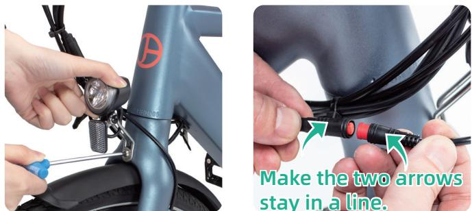
4.2. Stellen Sie den Winkel des Scheinwerfers so ein, dass die Straße vor Ihnen ausgeleuchtet wird. Methode zum Einstellen des Winkels: Lösen Sie den Scheinwerferwinkel und die Einstellschraube mit einem Kreuzschlitzschraubendreher, stellen Sie den Neigungswinkel des Scheinwerfers auf die beste Position ein und ziehen Sie dann die Schraube fest.
