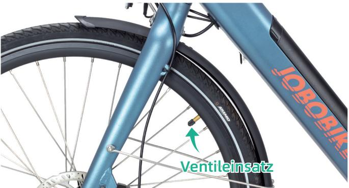
Prüfen Sie, ob die Reifenwülste und Reifen gleichmäßig auf den Felgen sitzen. Verwenden Sie eine Pumpe mit Schrader-Ventil und Manometer, um den empfohlenen Druck auf der Reifenflanke einzustellen.
