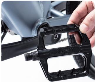
Serrer la pédale de droite dans le sens des aiguilles d'une montre et serrer la pédale de gauche dans le sens inverse des aiguilles d'une montre avec une clé de 15#.
