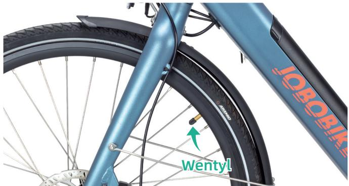
Upewnij się, że opony są odpowiednio osadzone na felgach. Użyj pompki wyposażonej w zawór Schrader oraz manometr, by dopominać każdą z opon do zalecanego poziomu ciśnienia, wskazanego na boku opony.
