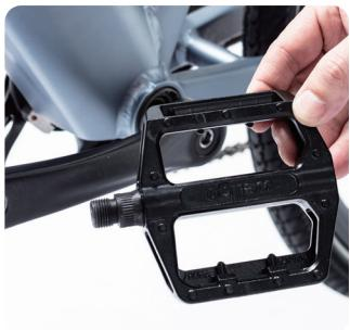
Ziehen Sie das rechte Pedal im Uhrzeigersinn und das linke Pedal gegen den Uhrzeigersinn mit **einem 15#-Schlüssel** fest.
