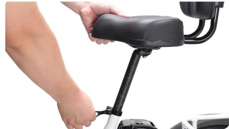
7.2 Schließen Sie den Schnallenhebel und vergewissern Sie sich, dass der Hebel beim Verriegeln der Sattelstütze ausreichend angezogen ist.
