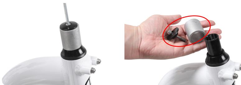
2.2 Montieren Sie den Lenkervorbau an der Vorderradgabel und ziehen Sie die Schraube bis zum Ende fest.
