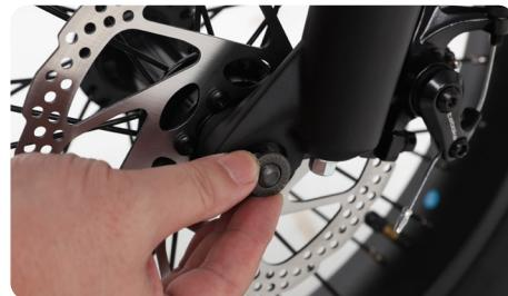
3.4 Schrauben Sie die linke und rechte Mutter mit zwei Schraubenschlüsseln zusammen und stellen Sie sicher, dass das Vorderrad fest an der Vordergabel befestigt ist.
