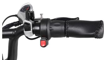
(13) Schalten Sie den Schalthebel mit der Taste "+" und "-" um, um die Geschwindigkeit an unterschiedliche Straßenbedingungen anzupassen.
